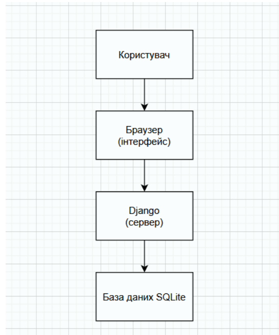
Рис. 1. Загальна структура взаємодії елементів веб-застосунку
