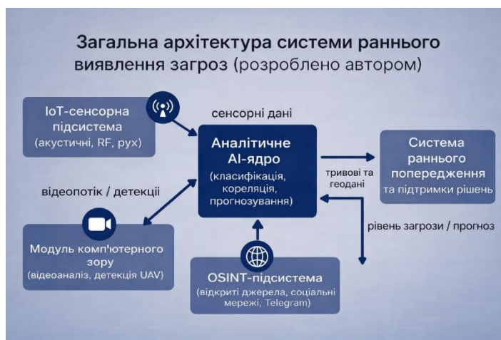
Рис. 1. Загальна архітектура системи (розроблено автором) (IoT-сенсори, Відео (CV) та OSINT дані сходяться в центральне AI-ядро, яке передає результат у блок «Система попередження»
