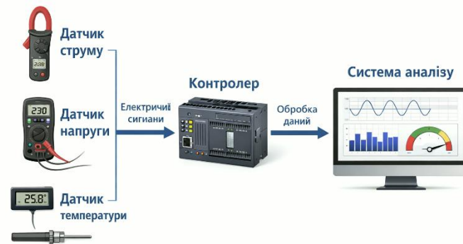
Рис. 1. Структурна схема типового діагностичного станда (датчики, контролер та система аналізу даних)
