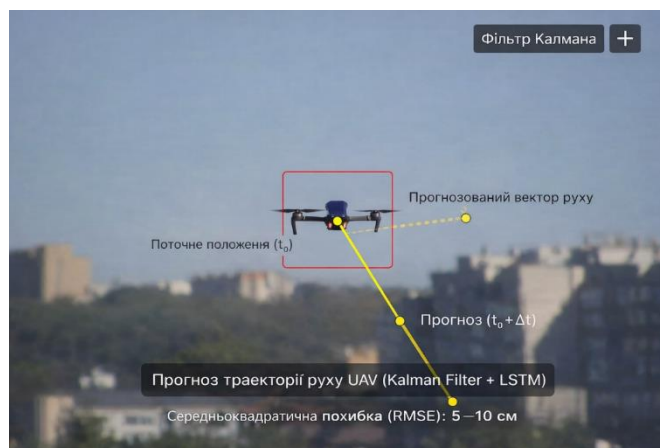
Рис. 2. Прогноз траєкторії дрона (Kalman Filter + LSTM) (Кадр відеопотоку з червоним bounding box навколо FPV-дрона на фоні міської забудови; жовта лінія показує прогнозовану траєкторію на 5–10 секунд вперед)
