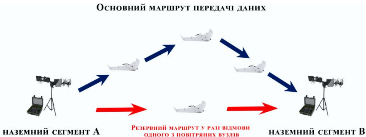
Рис. 1 Логічна модель відмовостійкої IP-мережі з повітряними вузлами зв'язку
