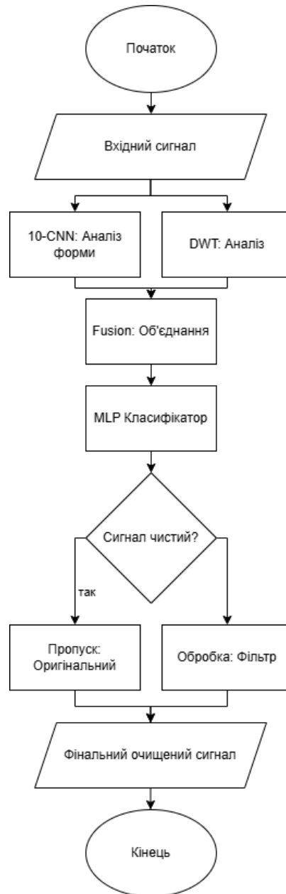
Рисунок 3.6: Блок-схема архітектури H-AD-CLEAN.
