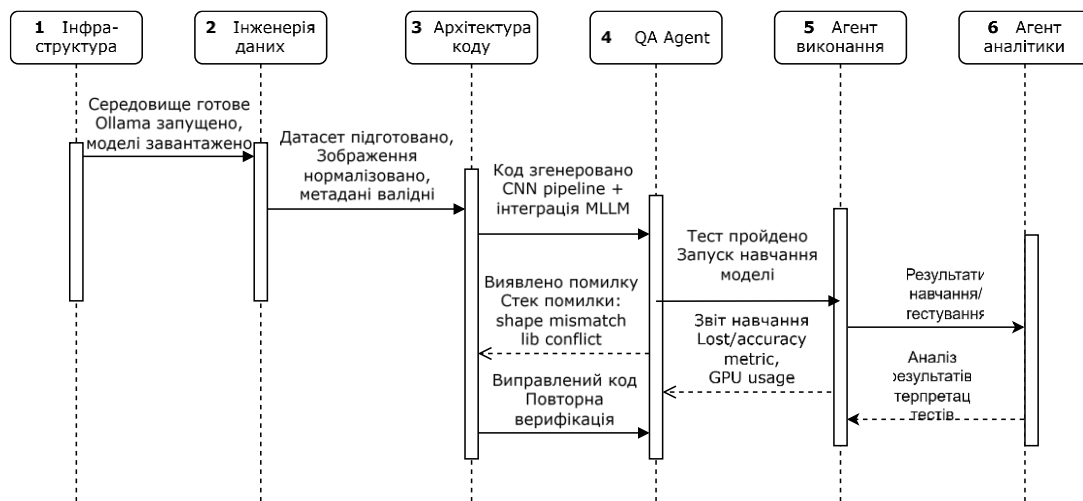
Рис. 3.3 – Взаємодія агентів MAC та ітераційний цикл самокорекції коду
