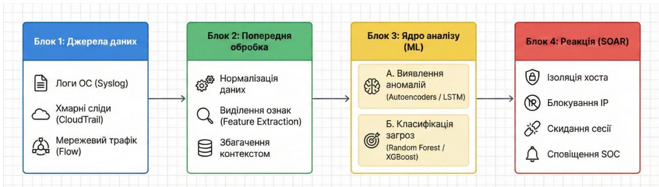
Рис. 2. Схема запропонованої архітектури автоматизованого конвеєра кібербезпеки
