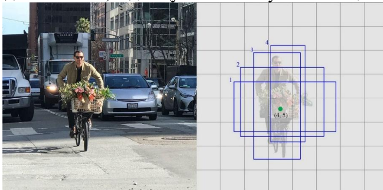
Рисунок 1 – Принцип SSD поділу візуального зображення для визначення об'єкта
