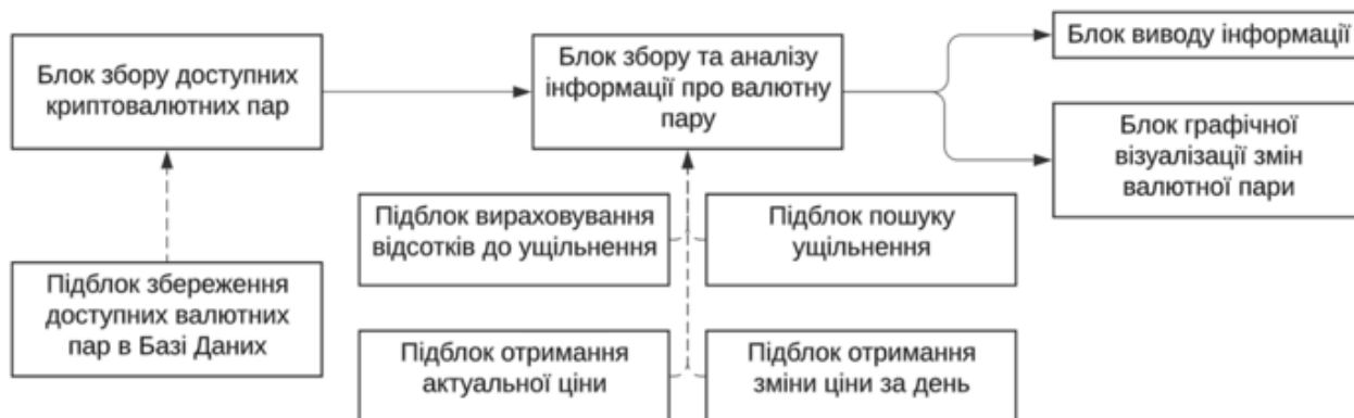
Рис. 2. Схема запропонованої системи збору даних
