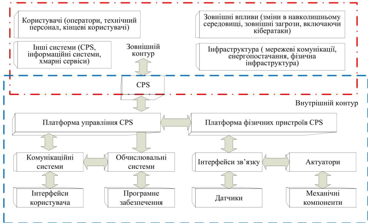
Рис. 1. Схема інтеграції та взаємодії компонентів кіберфізичної системи.
