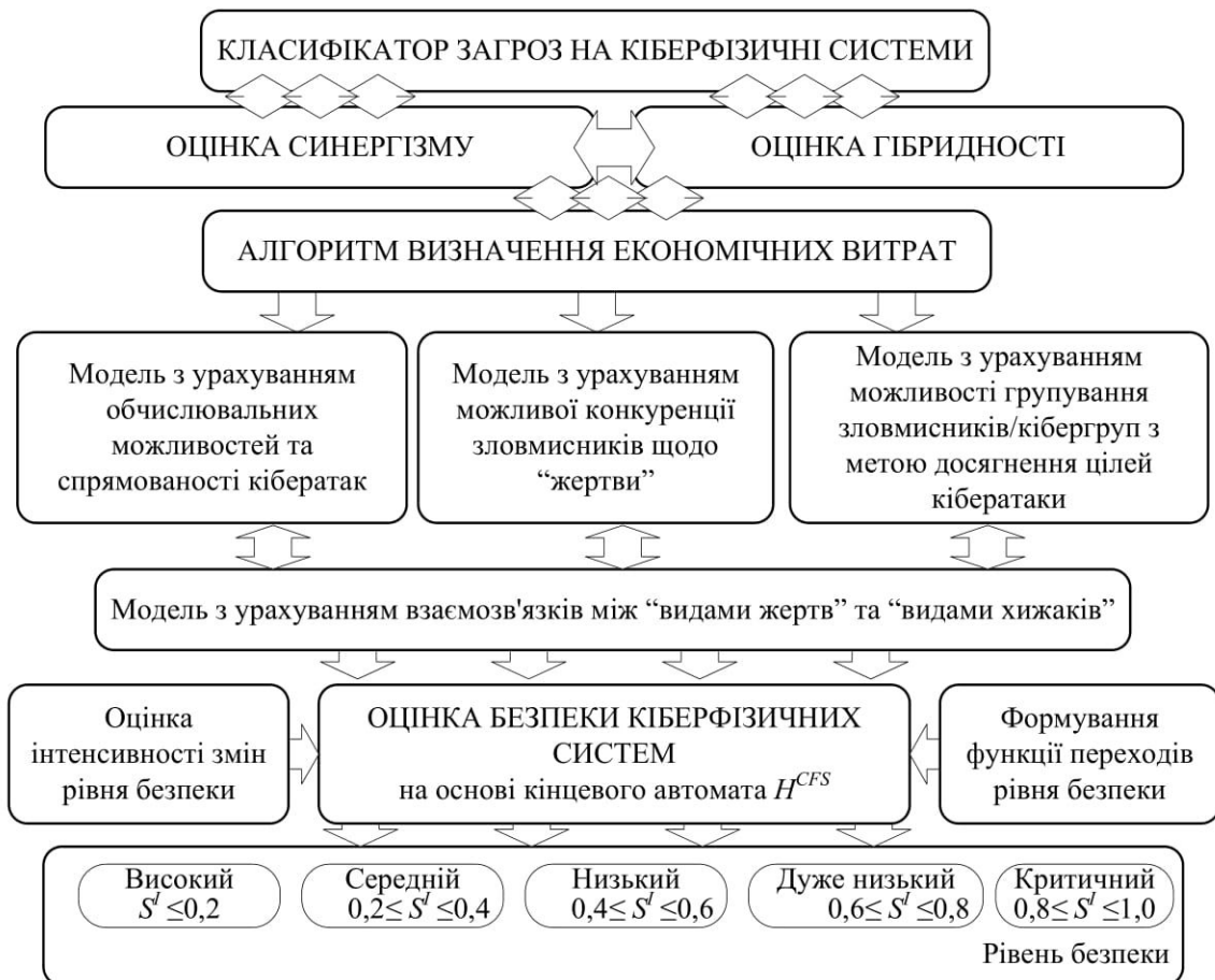
Рис. 3. Структурна схема методу оцінювання безпеки CPS на основі моделі Лотки-Вольтерри “хижак-жертва”
