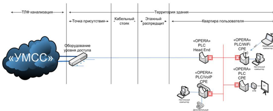
Рис. 3. Сценарий 2 применения Access BPL: «Замена квартирной разводки»
