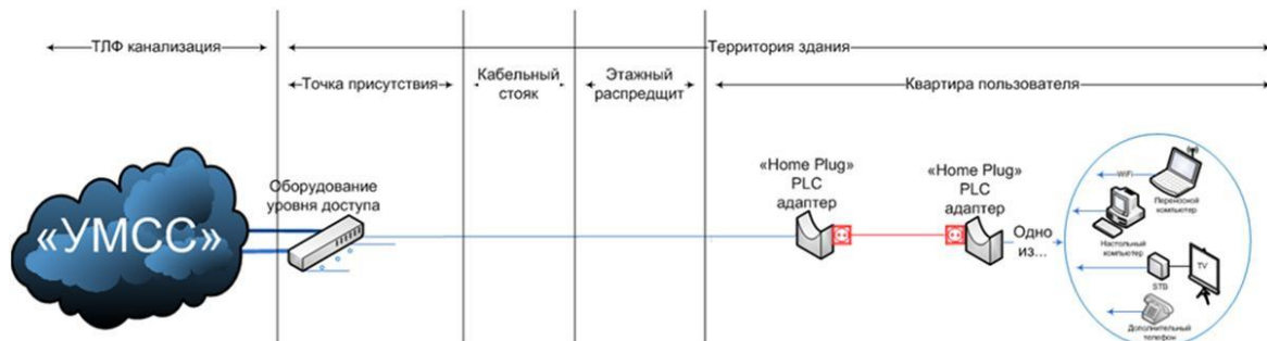
Рис. 2. Сценарий 1 применения SOHO BPL: «Замена квартирной разводки»
