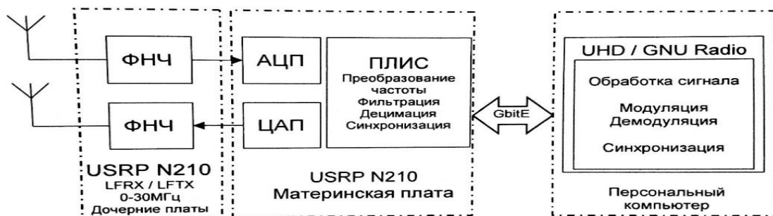
Рис 1.16 – Структурна схема платформи USRP в конфігурації для КХ діапазону
