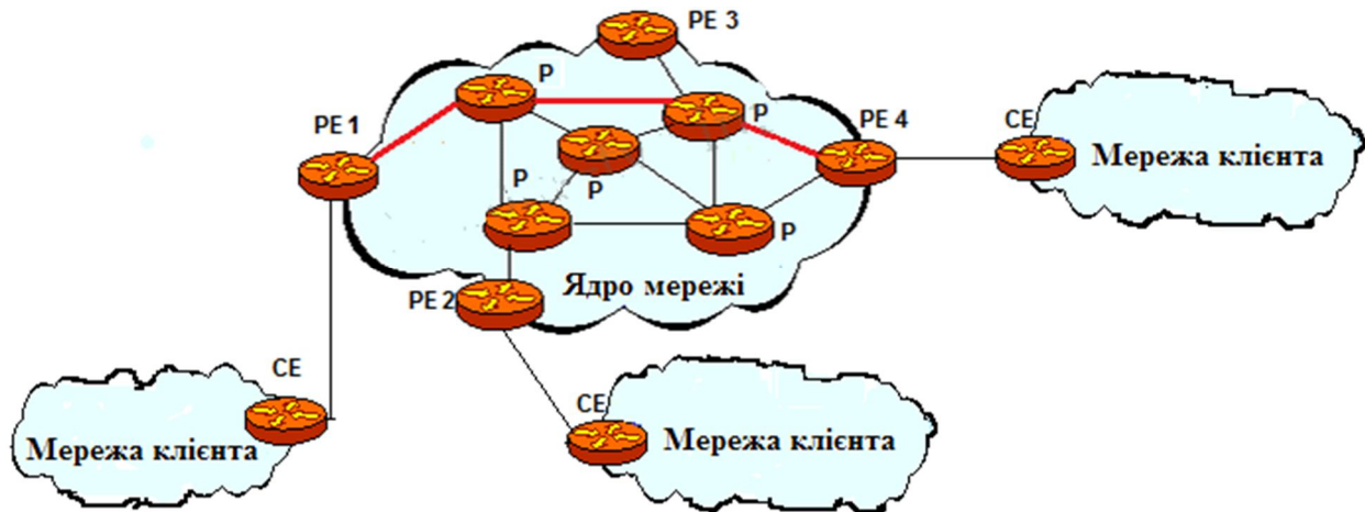
Рис. 1. Мережа провайдера на основі технології MPLS.
