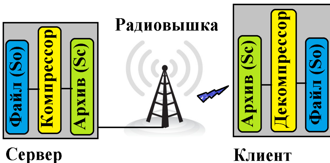
Рисунок 1 Применения компрессора, для передачи данных по сети
