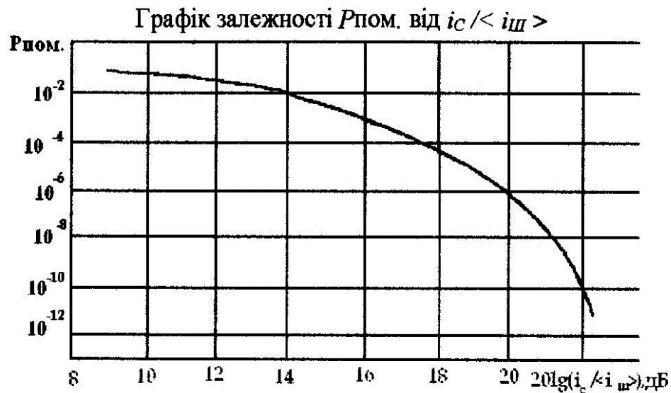
Рисунок 1 – Залежність коефіцієнта помилок від співвідношення струму сигналу до струму шумів
