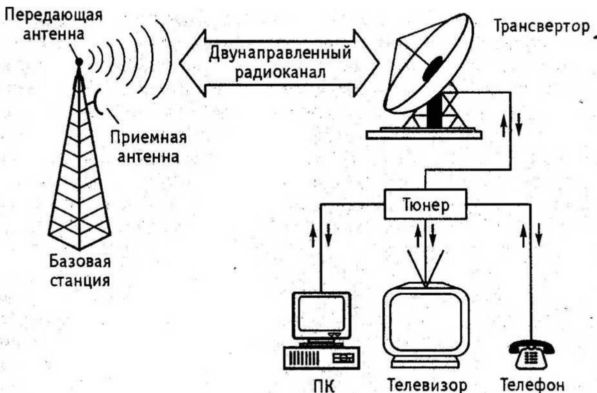
Рис. 5.3. Функциональная схема двунаправленной радиосистемы широкополосного доступа
