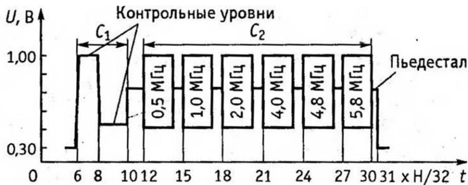
Рис. 6.4. Осциллограмма измерительного сигнала 2
