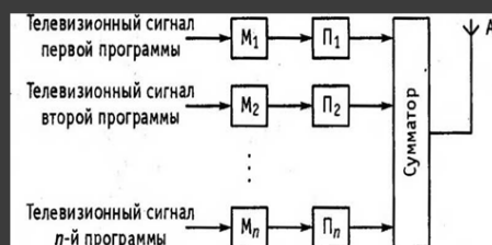
Рис. 5.1. Функциональная схема системы MMDS при использовании одноканальных радиопередатчиков: М - модулятор; П - передатчик; А - антенна
