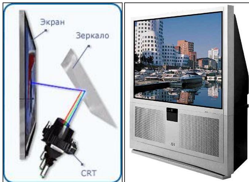
Рис. 59. Формирование изображения в проекционном кинескопном телевизоре и пример проекционного кинескопного телевизора
