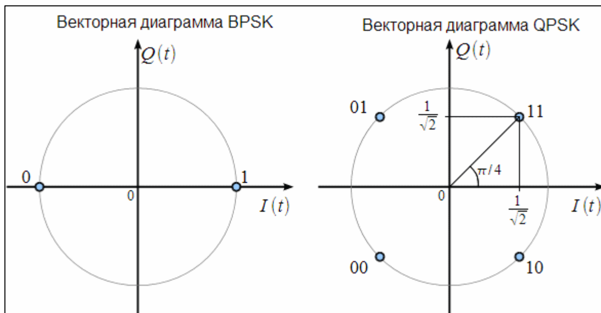
Рис.20. Векторная диаграмма BPSK и QPSK сигналов
