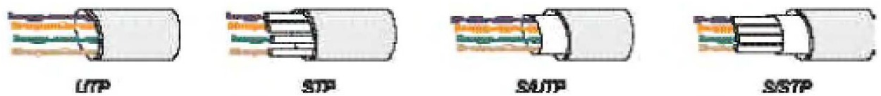
. Рис.22. Конструкції горизонтальних кабелів
