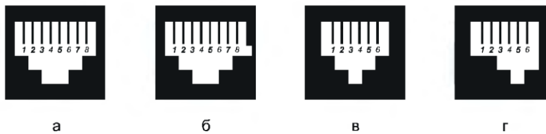
Рис. 59. Разновидности розеток модульных разъемов: а) восьмиконтактная; б) восьмиконтактная с ключом; в) шестиконтактная; г) шестиконтактная модифицированная
