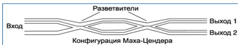
Рисунок 2.13 – Распределение входного сигнала между двумя выходами
