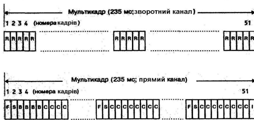
Рис. 2.2. Структура мультикадра каналу управління ефірного інтерфейсу системи GSM:
