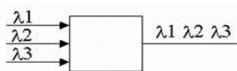
Рис. 1.3. Схематичне зображення функціонування мультиплексора.
