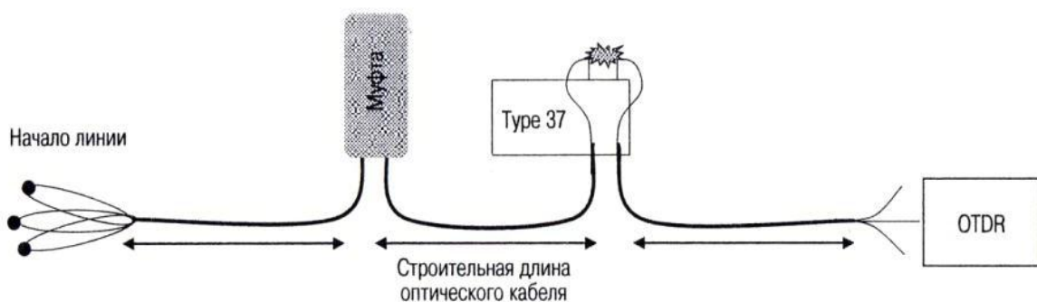
Рис. 6.5. Схема вимірювань рефлектограм на зростках методом шлейфу.
