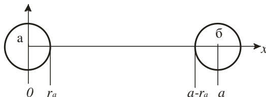
Рисуюнок 8 – Пояснення до розрахунку ємності симетричного кабельного кола
