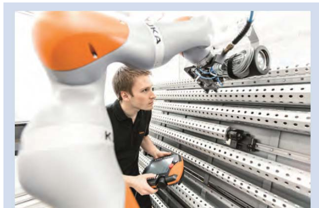
Рис. 71. Робот KUKA LBR iiwa виконує операції разом з людиною
