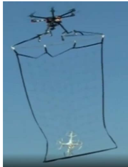
Рис. 94. Загальний вигляд квадрокоптера для ловлі летальних апаратів (Японія)
