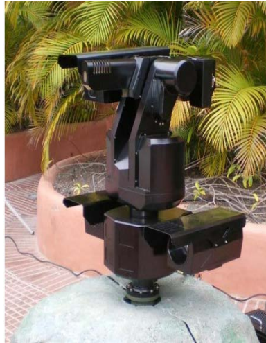
Рис. 112. Робот-вартовий (Intelligent Surveillance and Guard Robot) SGR-1
