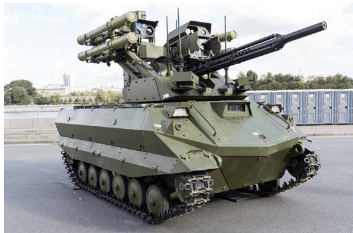
Рис. 113. Роботизований бойовий автомобіль «Уран-9»
