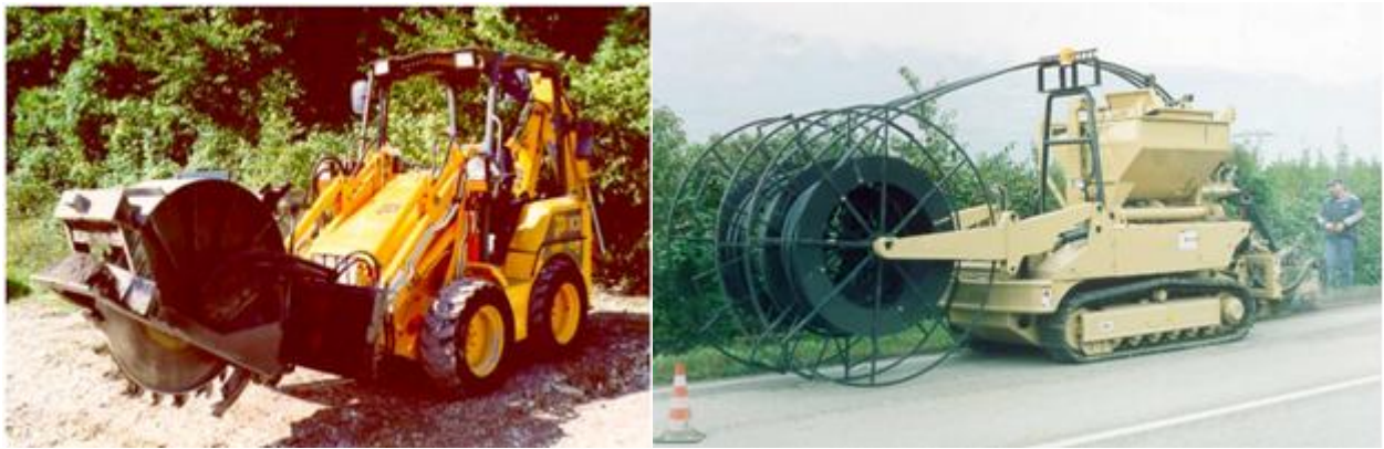
Фото 1 Приклад обладнання для прокладання кабелю мінітраншейним методом (відповідно до рисунку 2/L.48 та 3/L.48 рекомендації ITU L.48).
