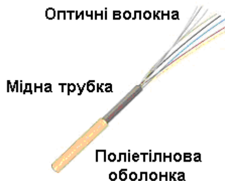
Рисунок 3.8 Приклад кабелю для мікротраншейного методу прокладання
