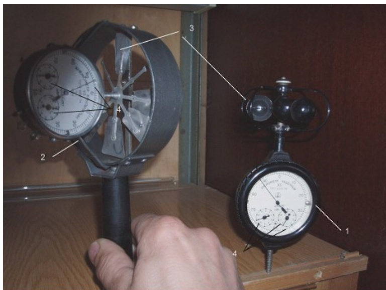
Рис.2.2 - Анемометри: 1 – чашковий; 2 – крильчатий; 3 – датчики швидкості повітряного потоку; 4 – вимірювальні шкали
