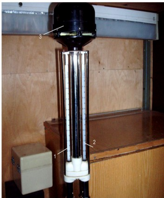
Рис. 2.1 - Аспіраційний психрометр Ассмана: 1 – «сухий» термометр; 2 – «вологий» термометр; 3 - вентилятор
