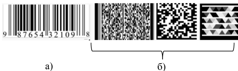
Рис. 3.1.6. Приклади штрих-кодів: а) лінійний; б) матричні двомірні (у тому числі кольорові)
