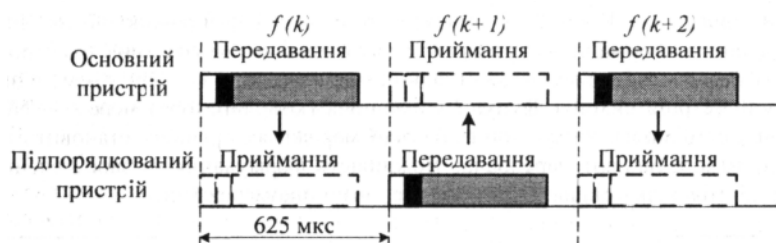
Рис. 8.76. Часова діаграма роботи каналу Bluetooth
