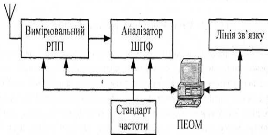
Рис. 4.4 Структурна схема системи вимірювання частоти методом ШПФ
