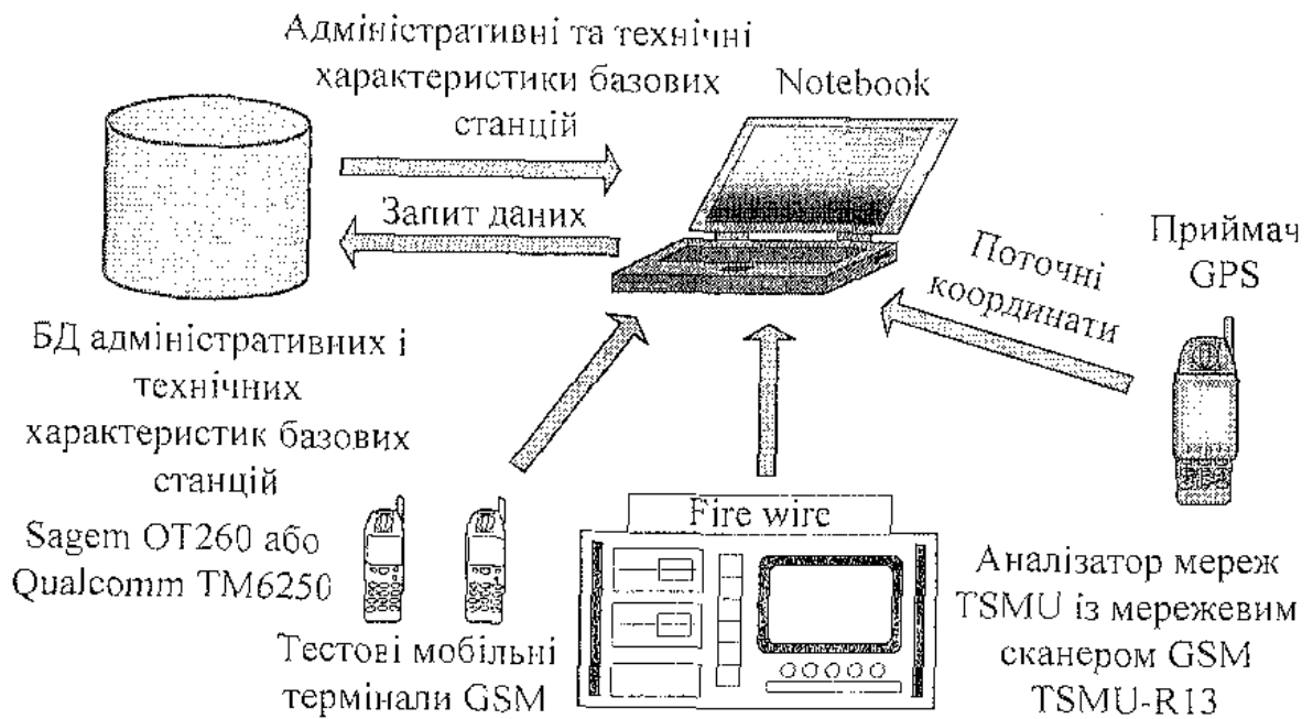
Рис. 9.26. Функціональна схема моніторингу мереж стандарту GSM В режимі контролю мереж стандарту GSM комплекс „ROMES” (із модулем „ROMES-GS3”) забезпечує:
