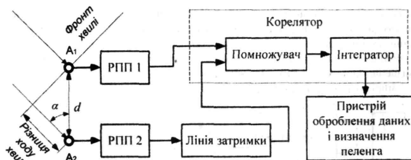
Рис. 5.19. Структурна схема кореляційного радіопеленгатора
