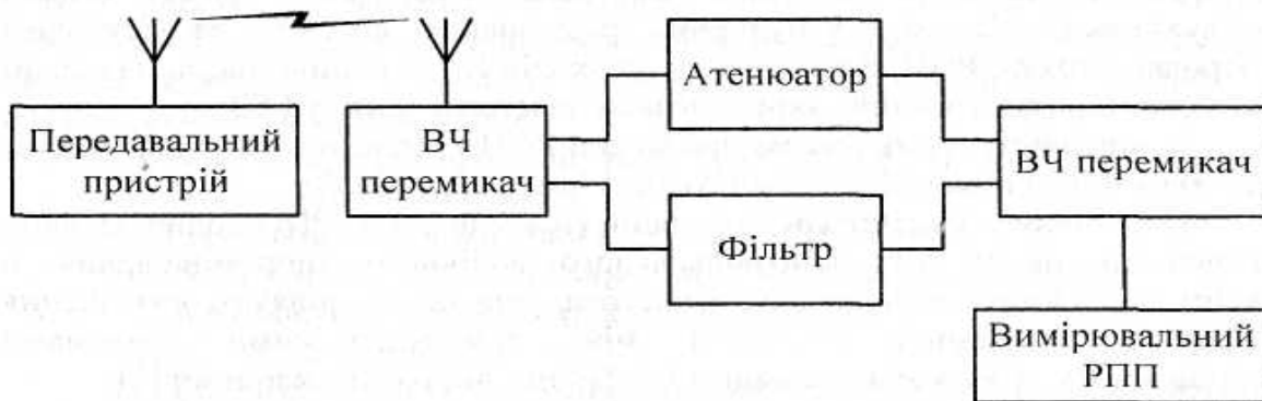
Рис. 4.11. Структурна схема дистанційного вимірювання рівнів побічних випромінювань
