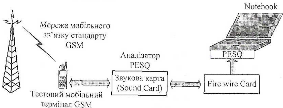
Рис. 9.27. Функціональна, схема каналу контролю якості звуку
