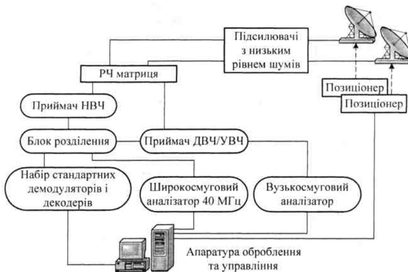
Рис. 9.3. Блок-схема станції радіомоніторингу випромінювання РЕЗ супутникового зв'язку
