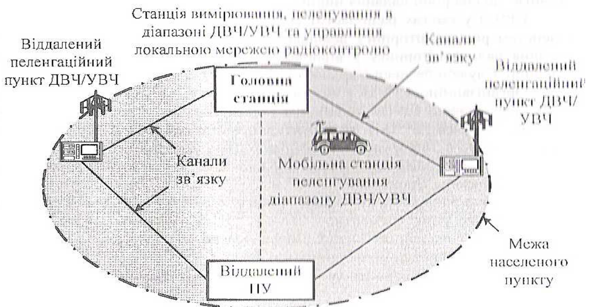
Рис. 10.7. Орієнтовна схема розташування елементів локальної системи радіомоніторингу
