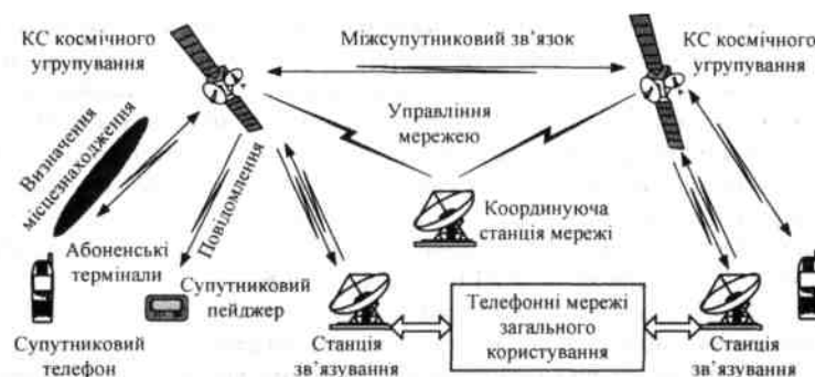
Рис. 8.48. Схема організації зв'язку в системах Inmarsat, Globalstar та Iridium
