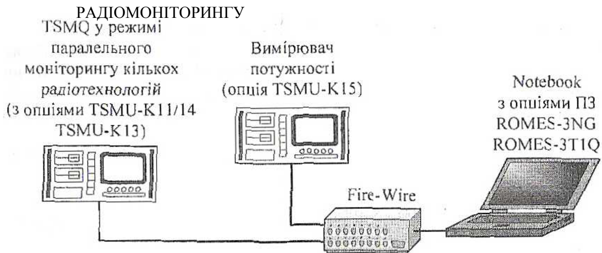
Рис. 9.24. Функціональна схема застосування аналізаторів TSMQ
