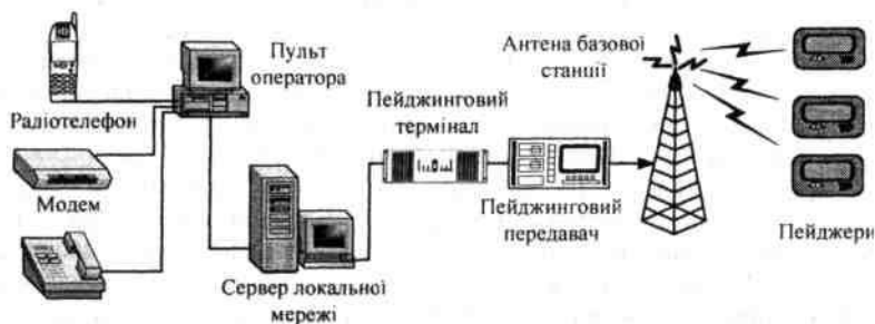
Рис. 8.64. Схема організації однозонової мережі пейджингового зв'язку
