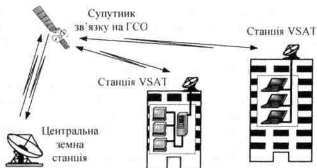
Рис. 8.47. Організація мережі фіксованого супутникового зв'язку із станціями типу VSAT за топологією „зірка”
