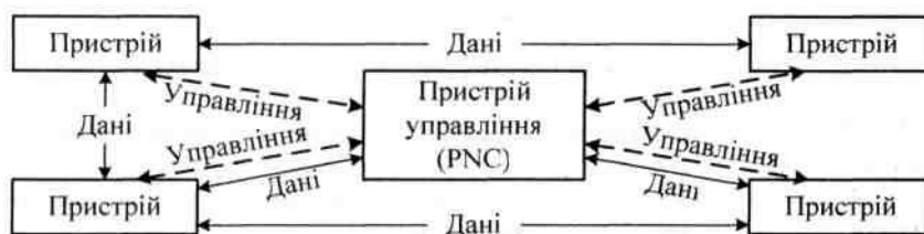
Рис. 8.77. Структура пікомережі IEEE 802.15.3
