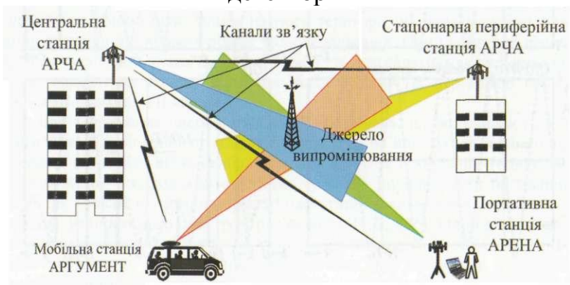
Рис. 9.19. Пояснення принципу роботи різних детекторів
