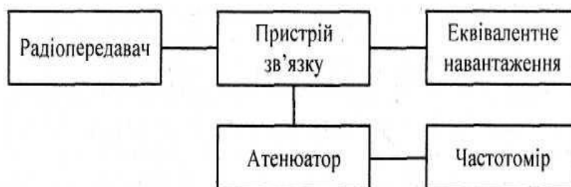
Рис. 4.1. Структурна схема вимірювання частоти радіопередавача із застосуванням електронно-лічильного частотоміра
