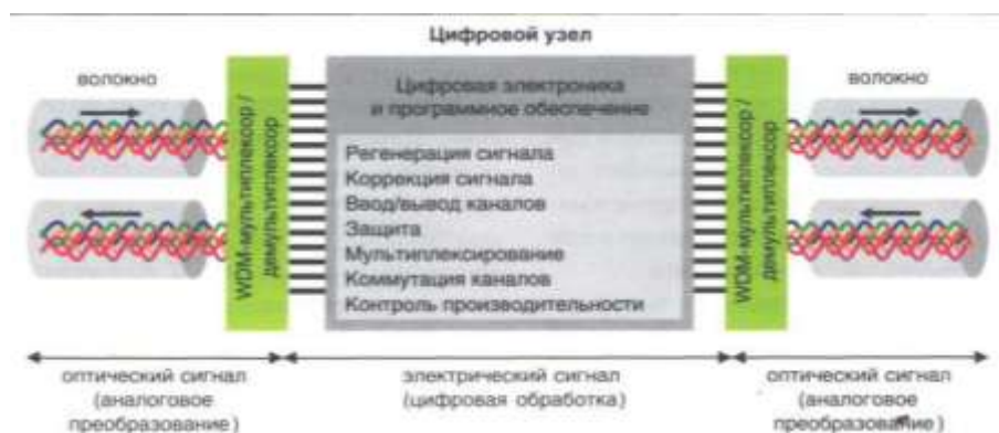
Рис.9.7 Цифровий вузол з ОЕО перетворенням
