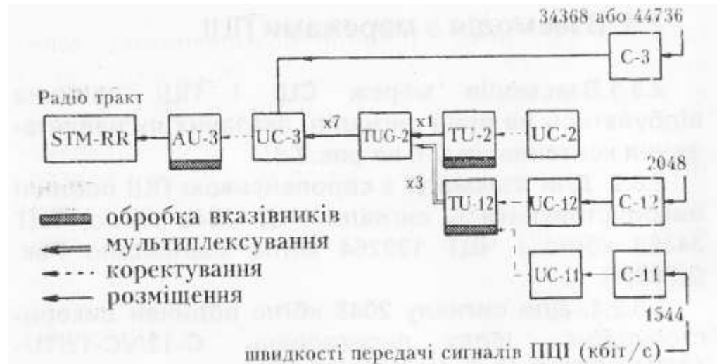
Рис.2.2 Схема перетворень для субпервинних радіоліній
