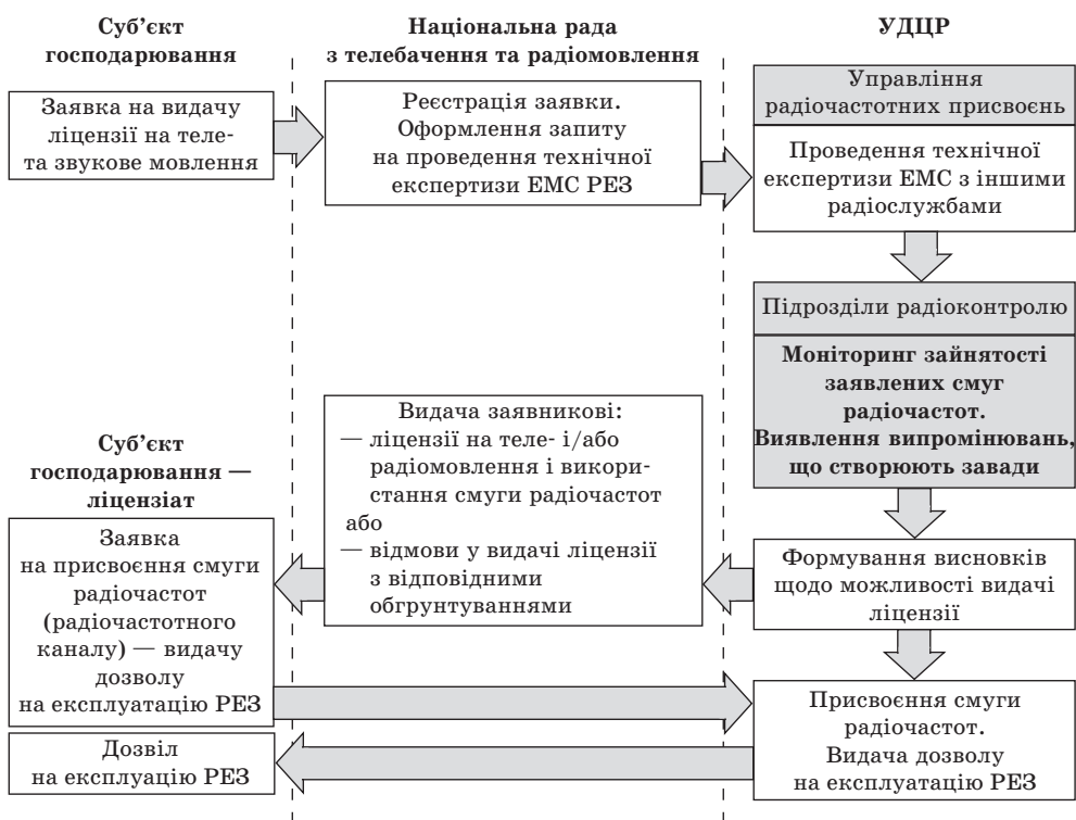
Рис. 9.6. Завдання радіомоніторингу при ліцензуванні та присвоєнні радіочастот для РЕЗ телевізійного та звукового мовлення
