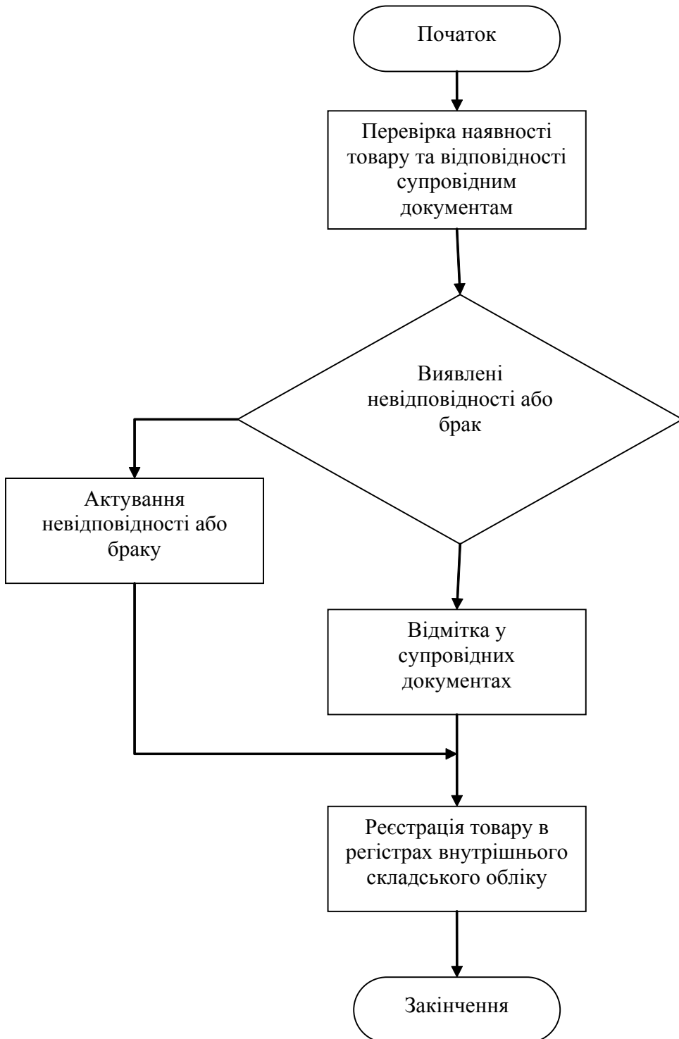
Рис. 5.10. Декомпозиція процесу на окремі роботи і операції
