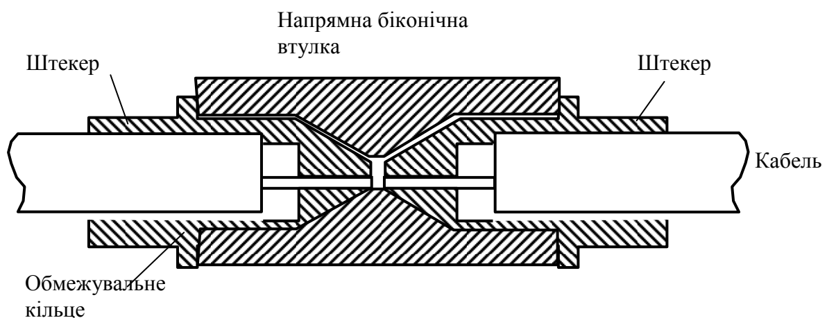
Рисунок 2.4 – Розріз конструкції з'єднувача з конічною втулкою
