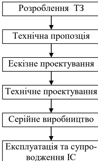
Рисунок 1.5 – Схема етапів проектування
