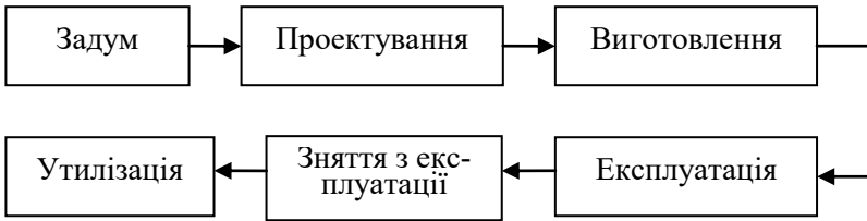
Рисунок 1.3 – Схема етапів життєвого циклу системи
