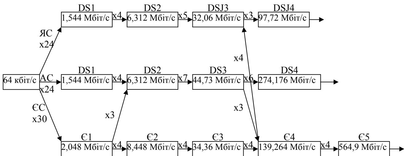
Рисунок 1.5.3.1 – Схема мультиплексування у американській АС, японській ЯС і європейській ЄС цифрових ієрархій.
