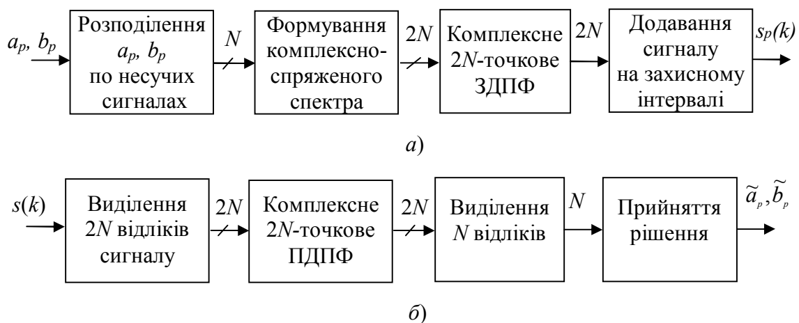
Рисунок 3.12 – Алгоритми багаточастотної модуляції-демодуляції:
