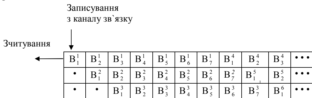
Таблиця 3.4 – Зворотне згорткове перемешування із глибиною b = 3 і розміром кодового слова n = 7
