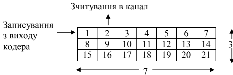
Таблиця 3.1 – Блокове перемежування з глибиною 3 і проміжком 7
