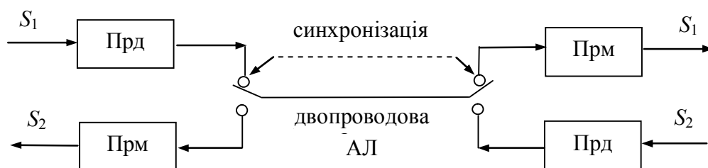
Рисунок 3.28 – Часове розділення сигналів зустрічних напрямків передавання: Прд – передавач СП; Прм – приймач СП
