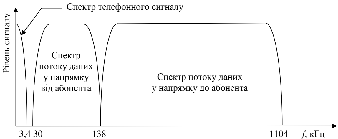
Рисунок 2.2 – Спектр лінійного сигналу ADSL (частотний поділ сигналів зустрічних напрямків)
