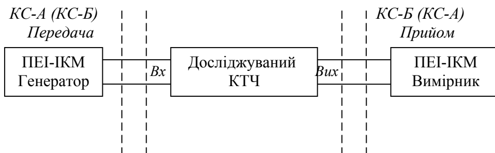
Рис. 5.1 – Схема вимірювання залишкового згасання, амплітудно-частотної характеристики, шумів квантування і шуму вільного КТЧ
