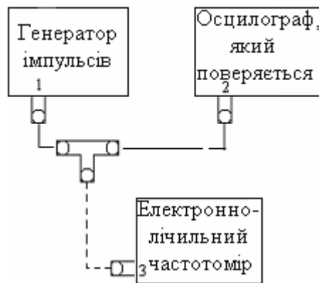
Рисунок А.6 – Схема вимірювання коефіцієнта розгортки, що не перевищує 5 мкс/ поділ:
