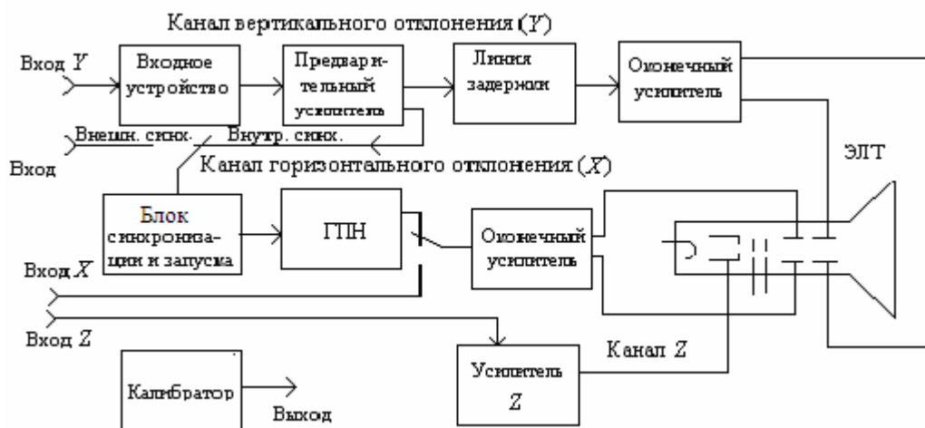
Рисунок 2.1 – Структурная схема универсального осциллографа
