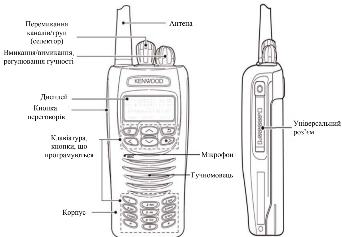
Рисунок 2 – Основні функціональні вузли інтерфейсу портативних радіостанцій NEXEDGE
