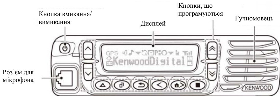
Рисунок 4 — Основні функціональні вузли інтерфейсу мобільних радіостанцій NEXEDGE
