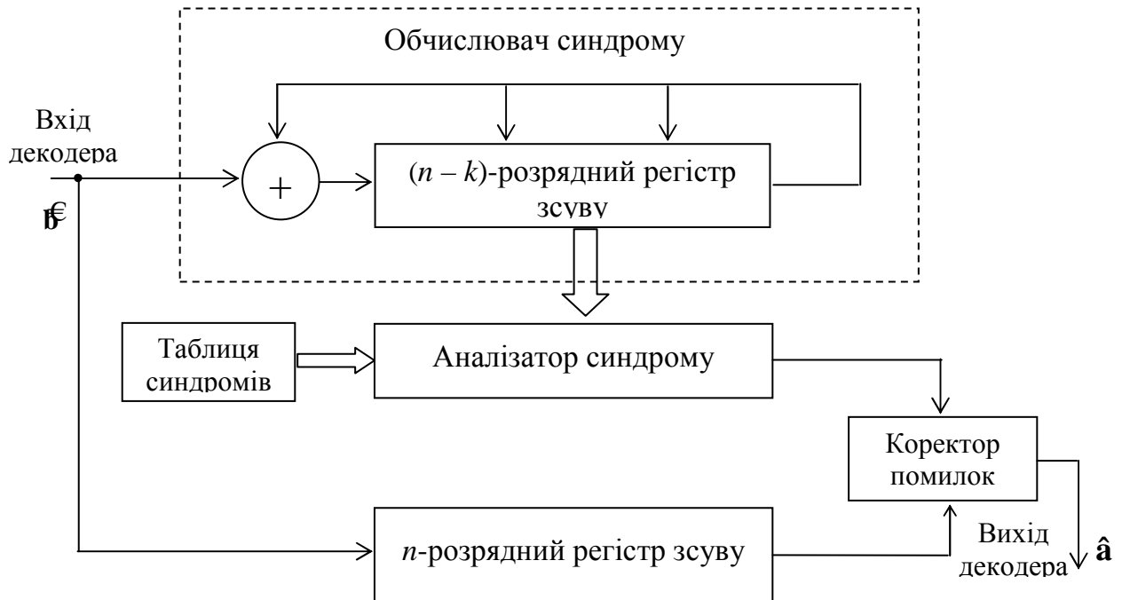
Рисунок 7.3 – Структурна схема декодера Меггітта блокового коду (n, k)
