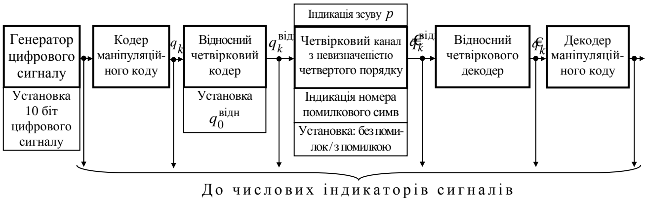
Рисунок 4.4 – Схема макета для вивчення четвіркового відносного кодування
