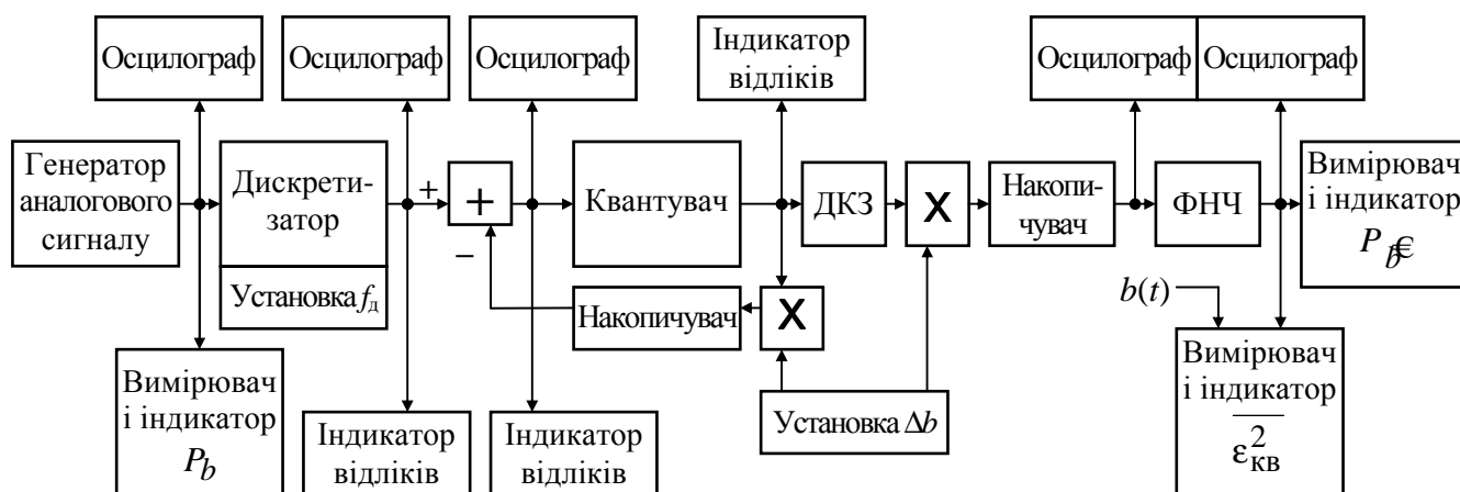
Рисунок 10.9 – Схема макета для дослідження методу ДМ
