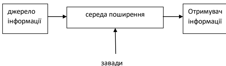
Рис. 1.1 Склад технічного каналу витоку інформації
