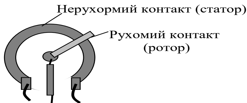
Рис. 1.5 Конструкція змінного резистора
