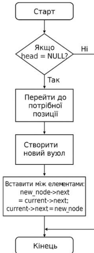
Рис. 4.3 Блок-схема алгоритму вставки елемента у довільну позицію
