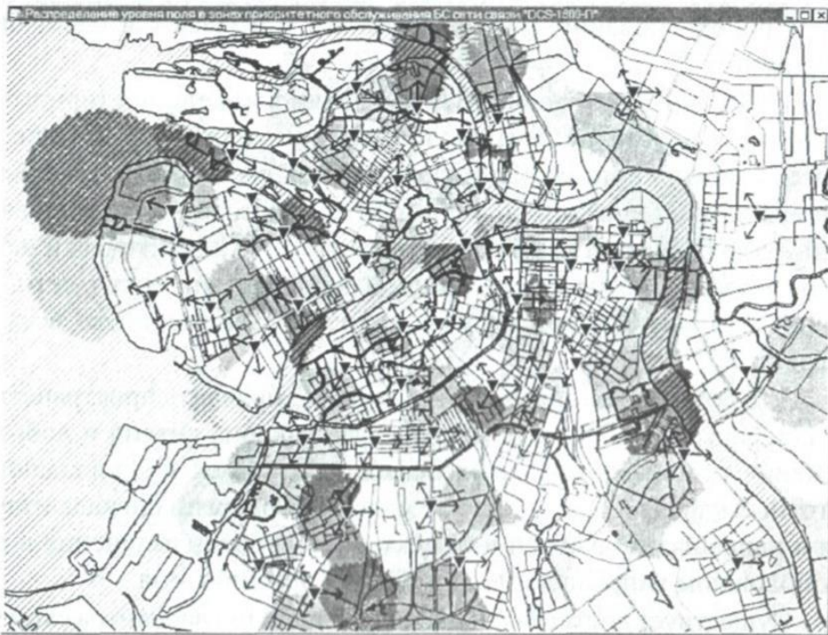
Мал. 9.48 Розподіл рівня поля в зонах пріоритетного обслуговування БС мережі зв'язку
