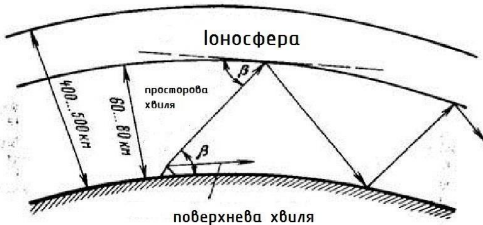
Рис.1.1.розповсюдження просторової та поверхневої хвиль
