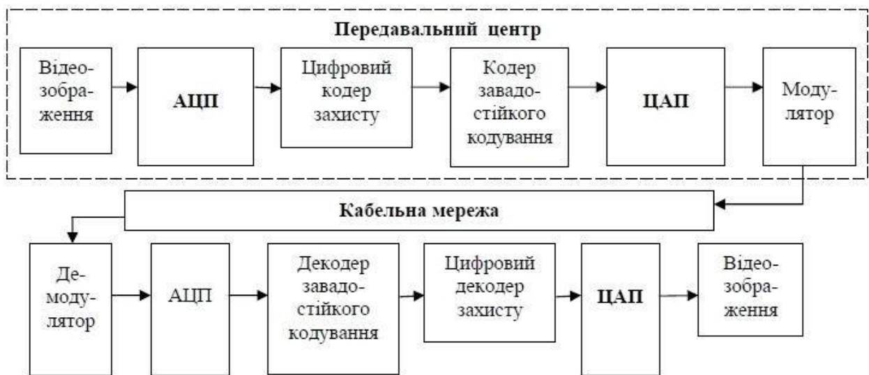
Рис. 3. Структурна схема цифрового методу закриття відеосигналу
