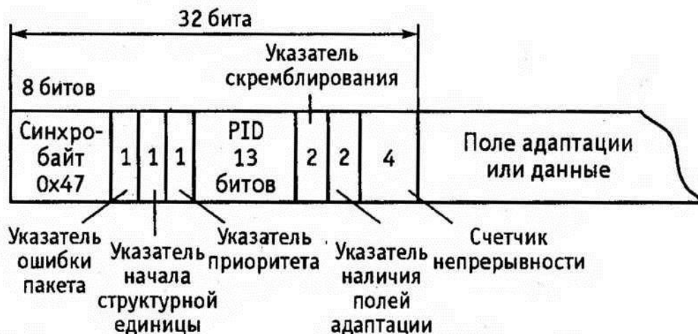
мал. 15. Структура заголовка пакета транспортного потоку
