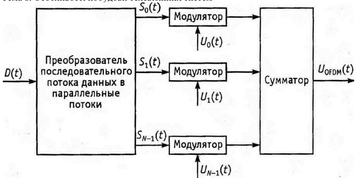
мал. 12. Функціональна схема пристрою модуляції типу ofdm
