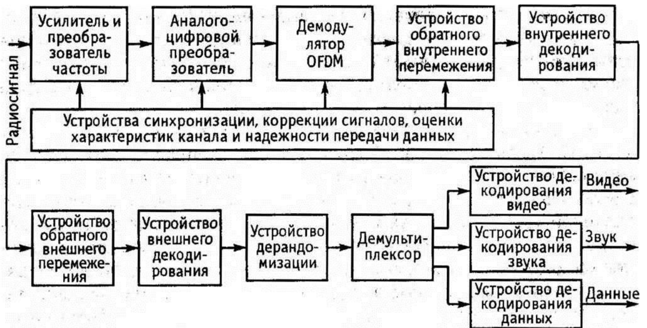
мал. 17. Структурна схема пристрою перетворення сигналів і даних в приймачі dvb-t
