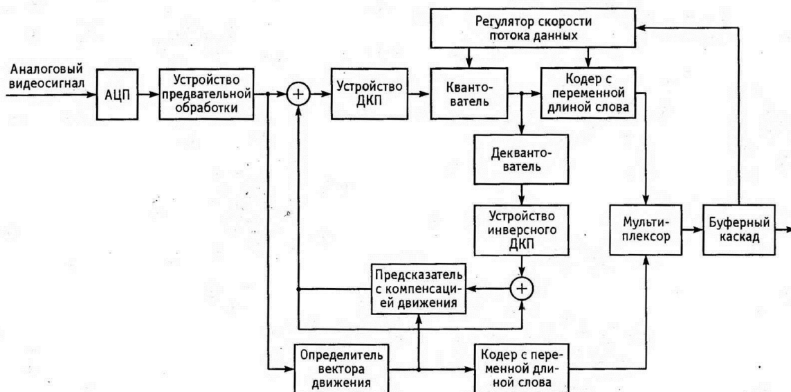
мал. 10. Функціональна схема пристрою кодування з інформаційним стисненням по стандартуmpeg-2
