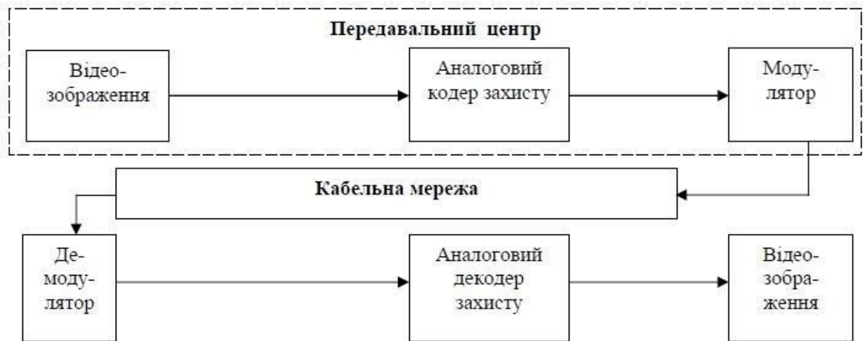
Рис. 1. Структурна схема аналогового методу закриття відеосигналу
