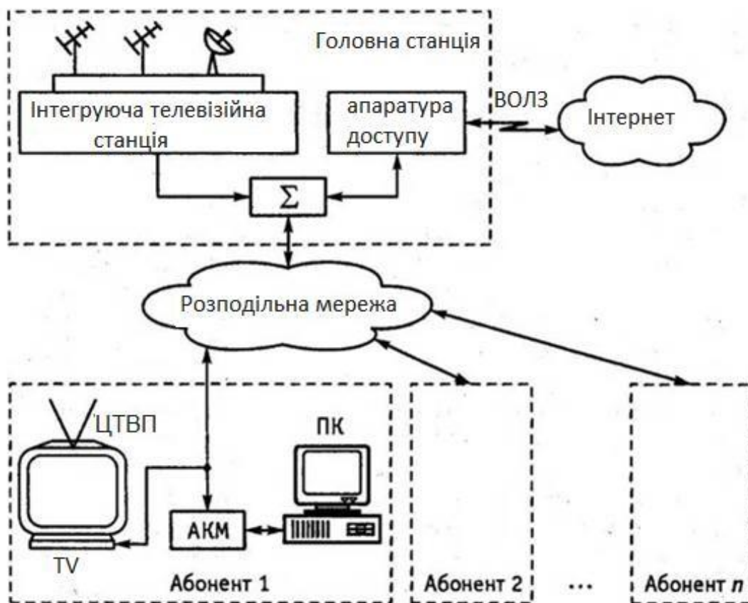
Мал.15. Функціональна схема цифрової мультисервісної мережі кабельного телебачення інтерактивного типу. X - суматор; цтвп - цифрова телевізійна приставка dVB-S
