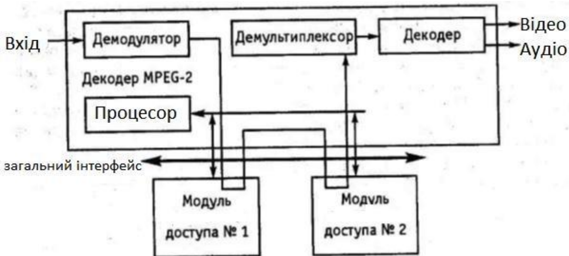
мал.4. Схема організації умовного доступу із загальним інтерфейсом
