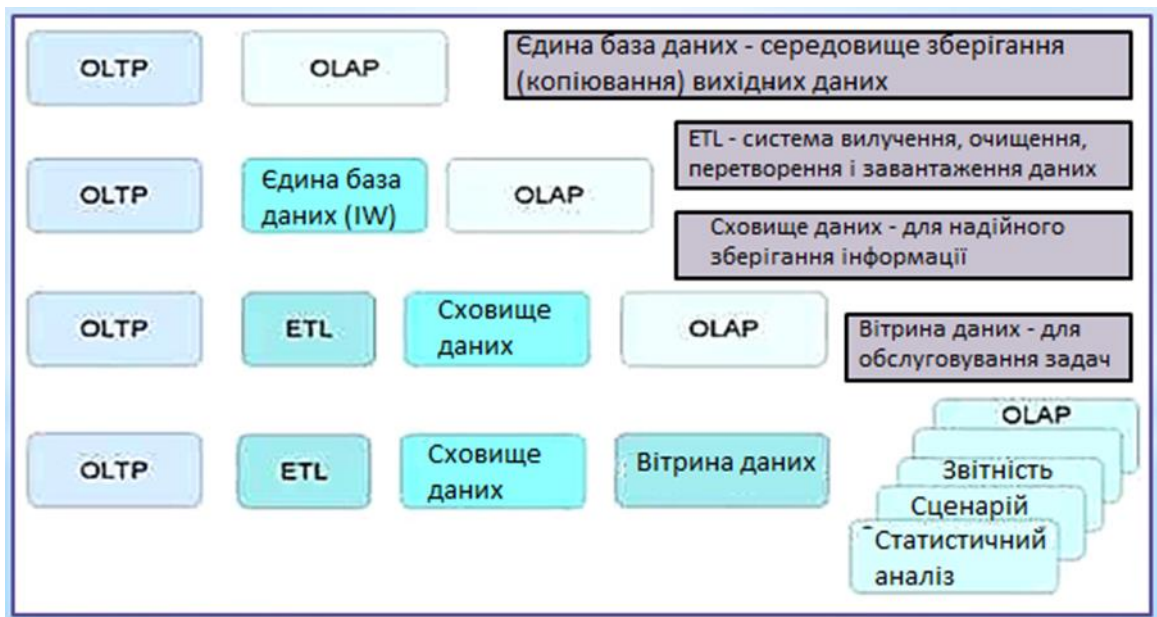
Рис.1.18. Еволюція розуміння місця OLAP в архітектурі обробки даних
