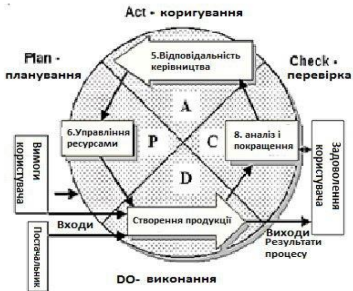
Рис.2.18. Циклічна модель або цикл PDCA
