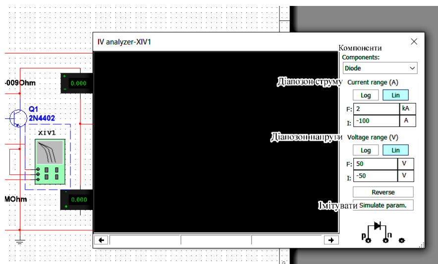
Рис.2.5.19 – Зовнішній вигляд інструмента для вимірювання вольт-амперної характеристики
