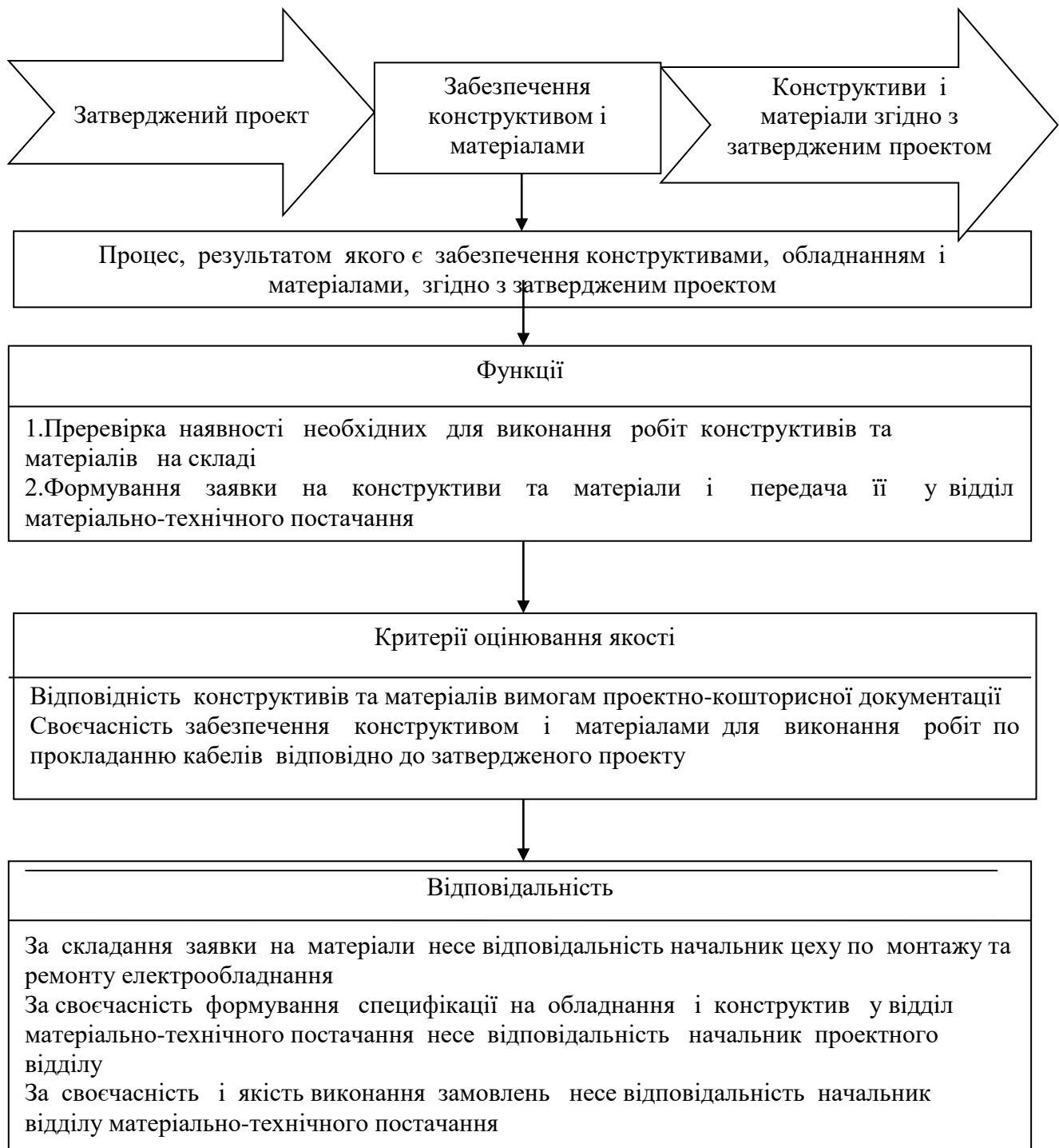
Рис. 8.15. Операційна процедура забезпечення конструктивом і матеріалами для виконання робіт по прокладанню кабелів відповідно до затвердженого проекту
