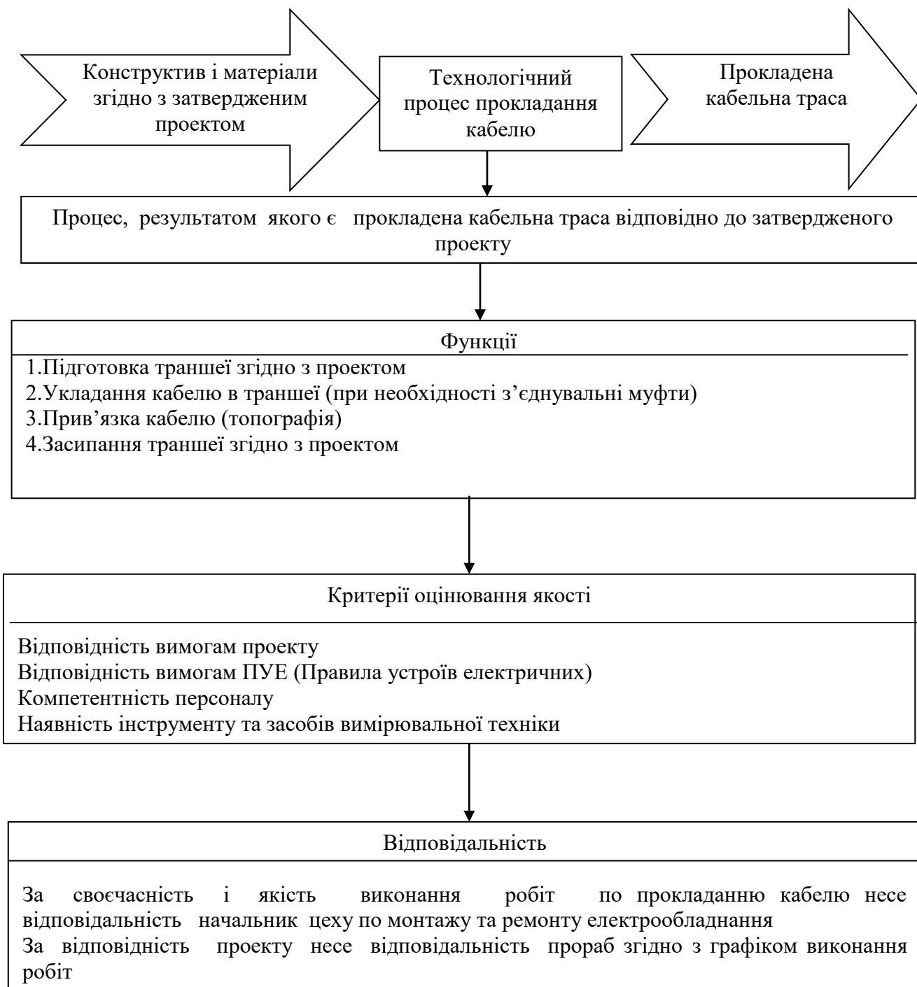
Рис. 8.16. Операційна схема технологічного процесу прокладання силових електричних кабелів
