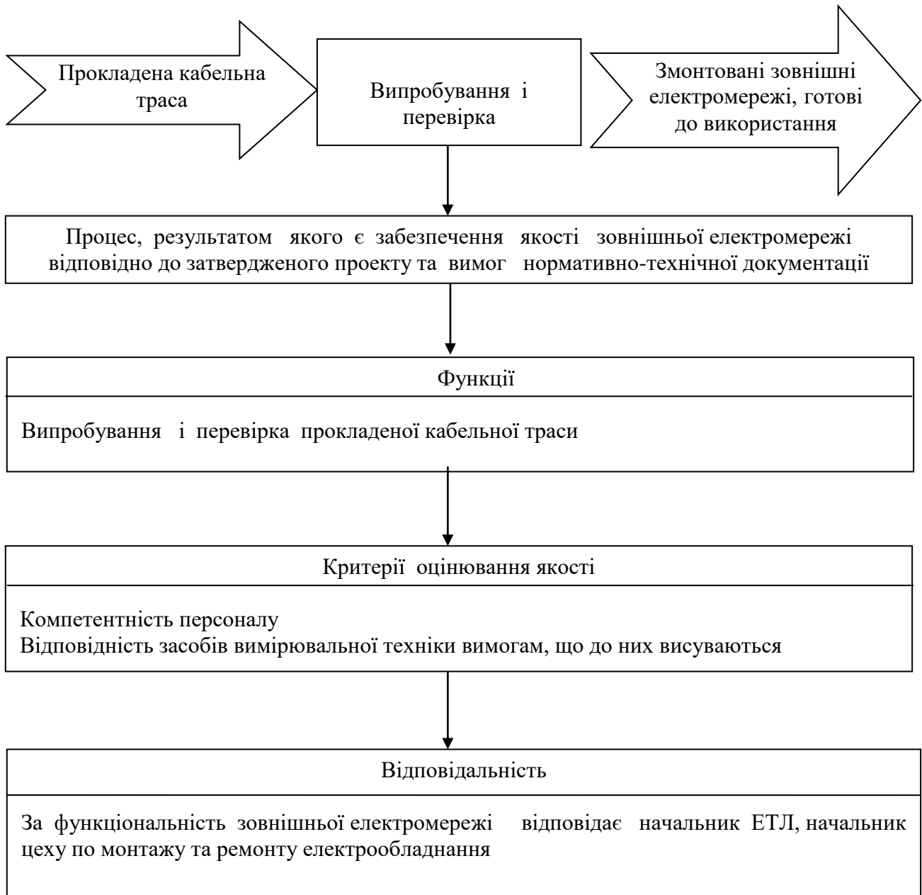
Рис. 8.17. Операційна процедура випробування і перевірки прокладеної кабельної траси
