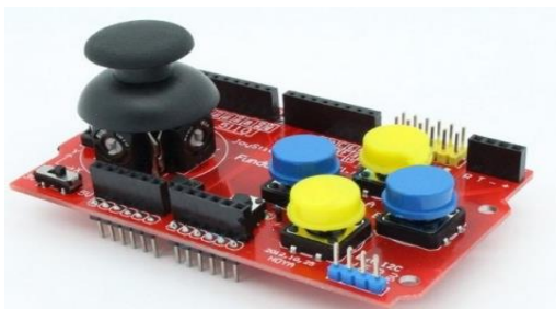
Рисунок 7.9 – Зовнішній вигляд Joystick Shield
