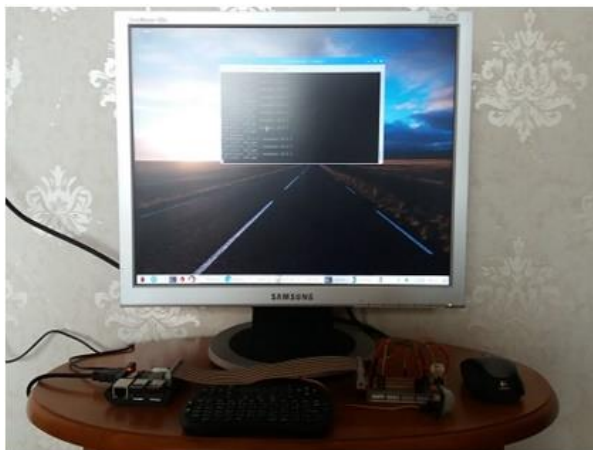
Рисунок 8.2 – Робоче місце на базі контролера Raspberry Pi 3 Model B
