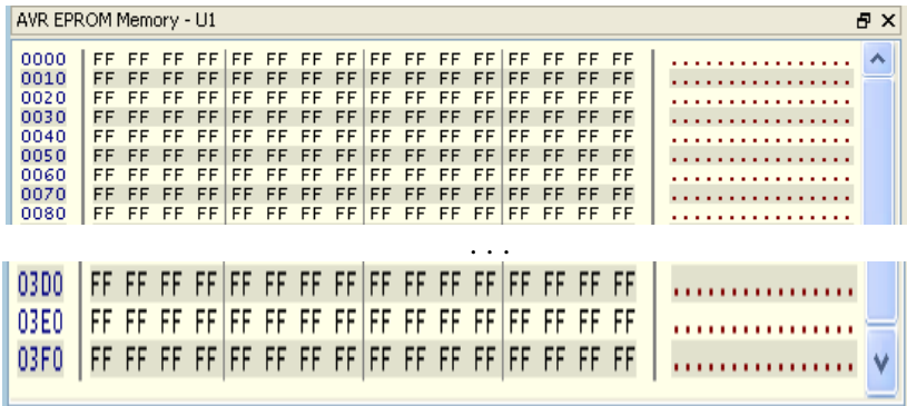
Рисунок 1.14 - Масив 1024 байт (1 Кб) енергозалежної пам'яті даних (EEPROM)
