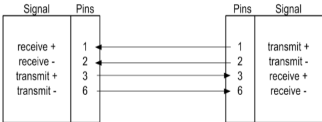
Рис. 1-8 – Схема контактов при прямом подключении
