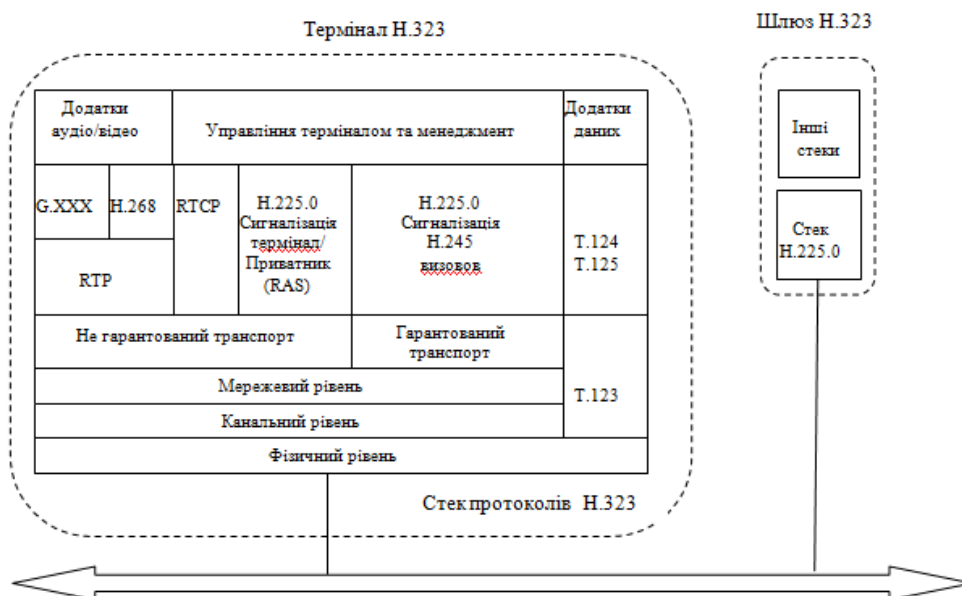
Рис.25. Додаток H.225.0 у стеку протоколів H.323
