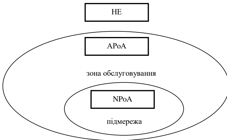
Рис.53. Функціональні елементи, залучені в обслуговування абонента при мобільності
